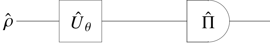
Rysunek 2.3: Schemat układu do pomiaru parametru \theta . \hat{\rho} jest macierzą gęstości stanu wejściowego, \hat{U}_\theta operacją unitarną opisującą działanie układu na stan wejściowy, zaś \hat{\Pi} oznacza pomiar dokonywany na końcu eksperymentu.
