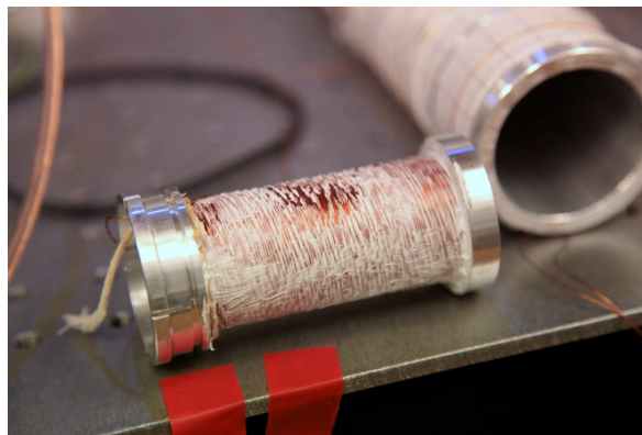
Rysunek 2.4: Jedna z dwóch bifilarnie nawiniętych cewek do podgrzewania komórki z rubidem.
