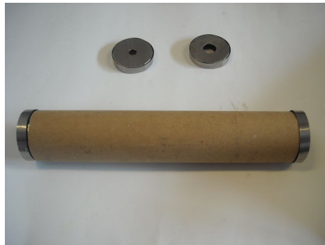
(b) Zewnętrzna warstwa ekranu wykonana z materiału amorficznego, wyprodukowana przez firmę Magneto z Częstochowy.
