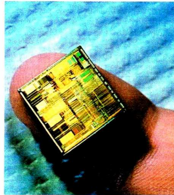
Rys 42.20. Układ scalony procesora Pentium wytwarzanego przez firmę Intel używany jest głównie w komputerach. Przed użyciem zostaje zamknięty w ceramicznej obudowie
