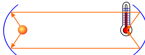
Rys. 14.8 Transmisja ciepła przy pomocy podczerwieni.
