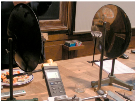
Rys. 14.9 Podczerwień chłodzi. Termometr widząc lód pokazuje 5°C.
