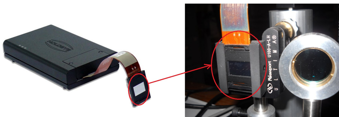
Rysunek 2.1: PLUTO: High-Resolution LCOS Phase Only Spatial Light Modulator. Po lewej stronie wygląd zewnętrzny modulatora fazy, po prawej stronie rysunku zdjęcie przedstawiające fragment modulatora – matrycę z macierzą komórek wypełnionych ciekłym kryształem. Dla pokazania wielkości urządzenia, na fotografii znajduje się także standardowa soczewka, używana w eksperymentach.
