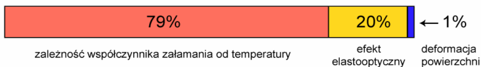
Rys. 4.3. Wkład poszczególnych czynników fizycznych na formowanie się soczewki termicznej w Ti:Al_2O_3
