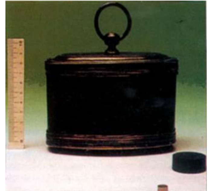
Magnetyt (z 1750 r.) typowy ferryt i magnes z ziem rzadkich. Każdy z nich o gęstości energii 1J.
