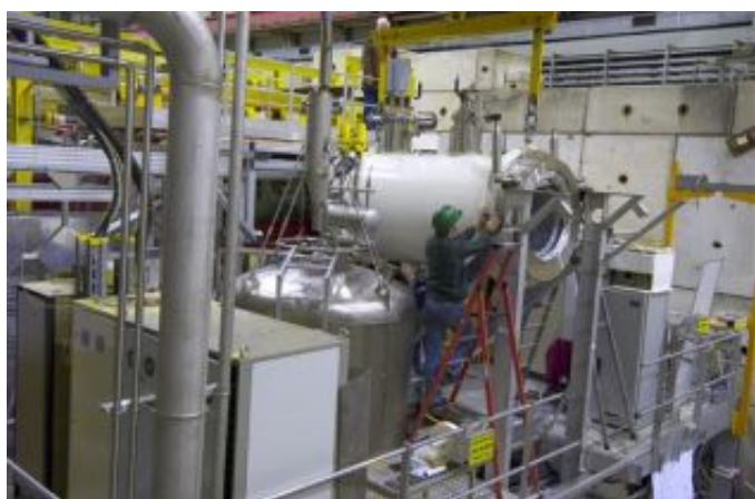
Eksperyment COMPASS - instalacja magnesu tarczy (źródło: CERN)
