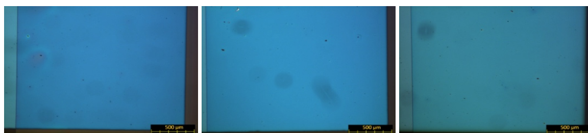
Rys. 4.2.1 Mikroskopia optyczna z kontrastem Nomarskiego gotowych ogniw (warstw aktywnych w obszarze pracy) mieszanin: (A) PTB7-Th:PC 60 BM (B) PTB7-Th:60IPH (C) PTB7-Th:60IPL [powiększenie X5]
