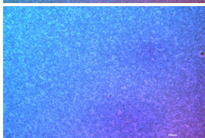
Rys. 4.4.12 Mikroskopia optyczna z kontrastem Nomarskiego gotowych ogniów (warstw aktywnych w obszarze pracy) mieszanin potrójnych PBDB-T-2F(BTP-4Cl-12:PC 70 BM) dla różnych dodatków do rozpuszczalnika. [Po lewej powiększenie X5. Po prawej powiększenie X20]
