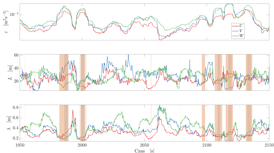
Rysunek 4.3.2 Wykres wielkości dla trzech składowych prędkości wiatru w czasie dla odcinka nr 1 znajdującego się na wysokości ok. 620 m. Górny panel – tempo dyssypacji energii kinetycznej turbulencji, środkowy panel – integralna skala długości, dolny panel – skala Taylora. Szarymi prostokątami zaznaczono lokalizację chmur. Pomarańczowymi prostokątami zaznaczono obszary w których LAM jest mniejsze niż 0,95
