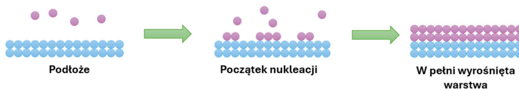
Rys. 11. Schemat demonstrujący wzrost epitaksjalny na podłożu krystalicznym.
