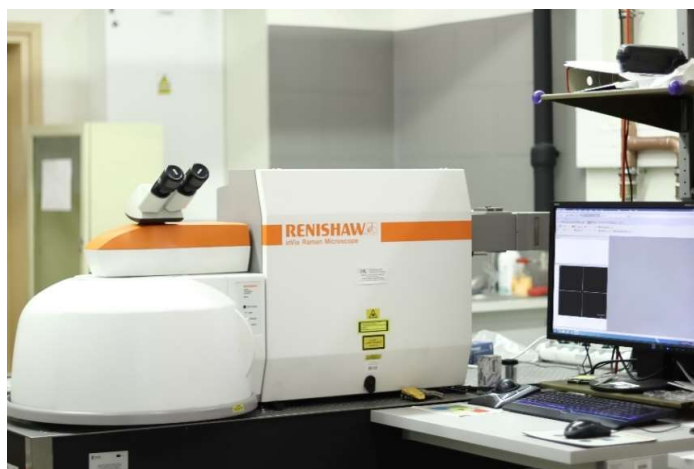
Rys. 49. Zdjęcie układu do pomiarów ramanowskich Renishaw.
