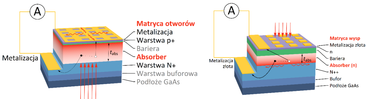
Rysunek 12. Projekty detektorów realizowane w pracy. Z lewej: schemat detektora fotowoltaicznego z matrycą otworów podfalowych w metalizacji wierzchniej. Z prawej: schemat detektora nBn z wysokodomieszkowanym półprzewodnikiem N++ i matrycą wysp metalicznych na powierzchni.
