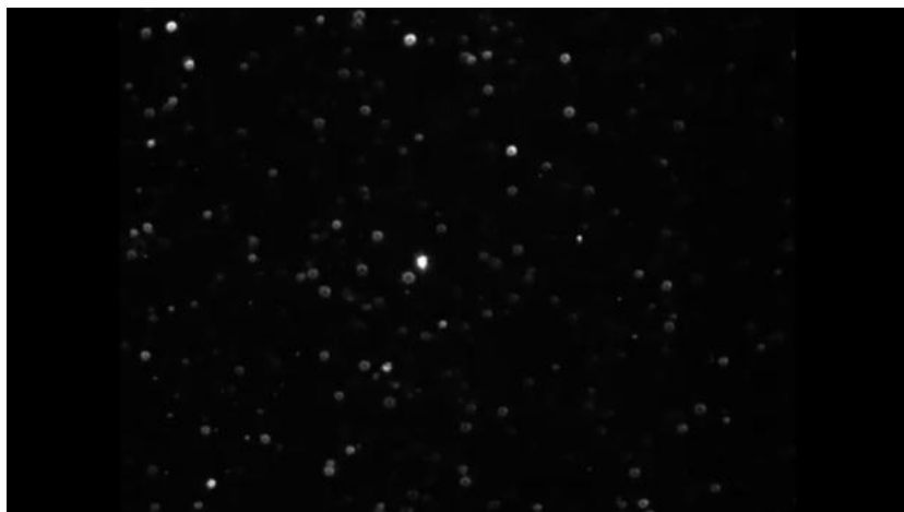
Rysunek 1: Pojedyncza klatka z filmu powstałego korzystając z analizy śledzenia nanocząstek. Na białą są widoczne obiekty odbijające światło lasera. W tym badaniu analizowano rozmiar pęcherzyków zewnątrzkomórkowych z komórek PC3.
