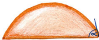
Rysunek 22: Schematyczny pęcherzyk o kształcie sferycznej czaszy. Zaznaczono kąt przylegania ( \alpha ) pęcherzyków do podłoża. W tym wypadku jest on mniejszy od 90^\circ (porównaj suplement do Ridolfi i in. (2020)).
