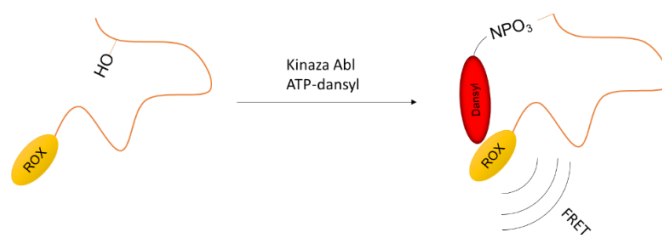
Rys. 22 Idea działania układu do poszukiwania inhibitorów kinaz. Po fosforylacji substratu resztą fosforanową wyznakowaną dansylem, zachodzi oddziaływanie między barwnikami, co można śledzić metodami spektroskopowymi. Rysunek na podstawie pracy Green et al. 98
