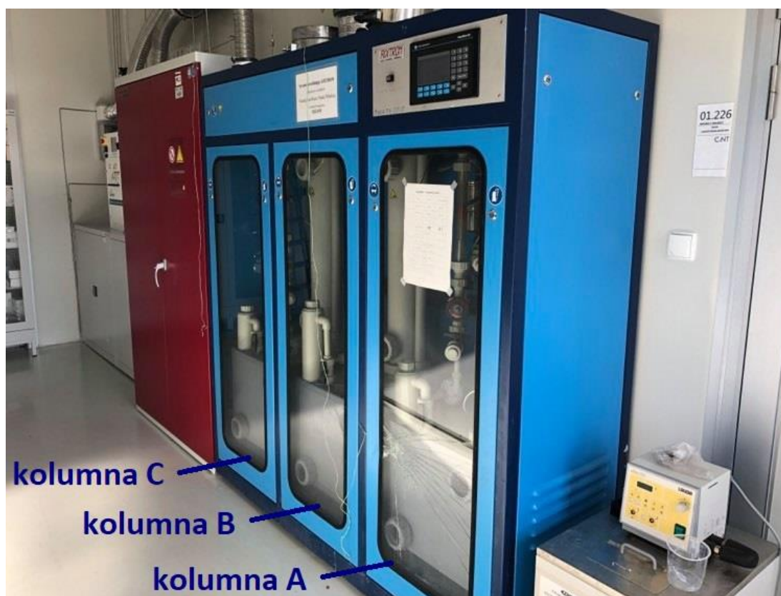
Rysunek 2.7 System oczyszczania gazów wylotowych ( scrubber ).
