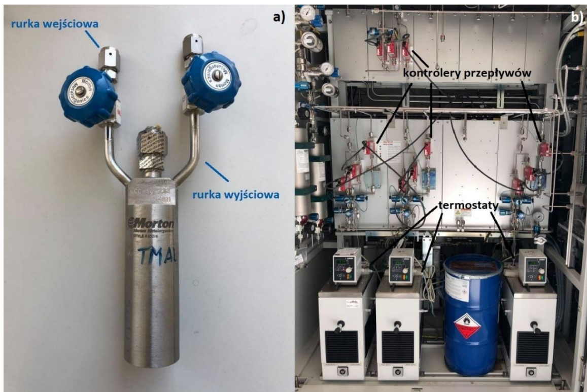
Rysunek 2.4 a) Pusty bubbler po wykorzystanej metaloorganice glinowej (TMAI), b) wnętrze szafy z bubblerami.
