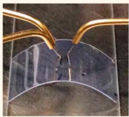
Rysunek 1.6 Zdjęcie przedstawia GFET (Flexible Graphene Field Effect Transistor) – tranzystor zbudowany z grafenu i obudowany heksagonalnym azotkiem boru [88].
