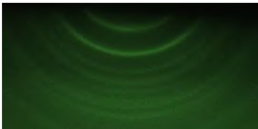
Rysunek 4.10: Obraz RHEED MoTe 2 wyhodowanego na szafirze. Charakterystyczne półokręgi świadczą o polikrystaliczności wyhodowanej warstwy. Próbką UW1601.
