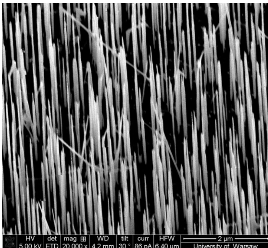
Rysunek 5.7: Zdjęcie SEM nanodrutów GaAs. Dzięki wzrostowi na podłożu o orientacji [111] druty rosną prostopadle do siebie. Średnica i gęstość drutów zależą od grubości złota naparowanego na powierzchnię podłoża. Niektóre druty złamały się i pochyliły w stronę podłoża. Wzrost został przeprowadzony przy wsparciu dr. hab. Janusza Sadowskiego. Zdjęcie SEM - Autor.
