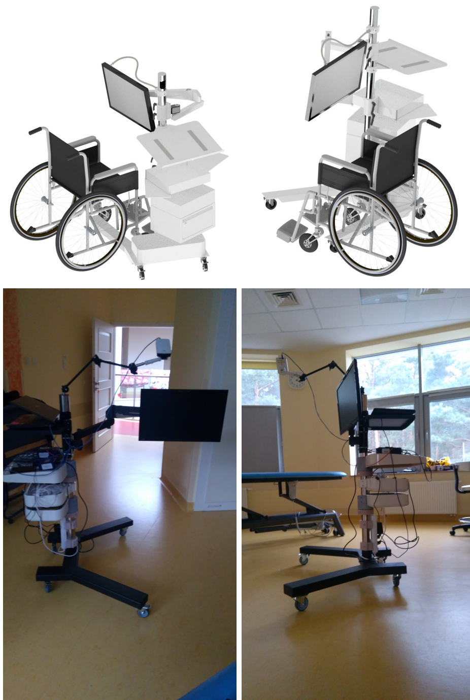
Rysunek 4.1. Ruchomy stojak do badań EEG w klinice „Budzik”, wizualizacja projektu oraz zdjęcia.
