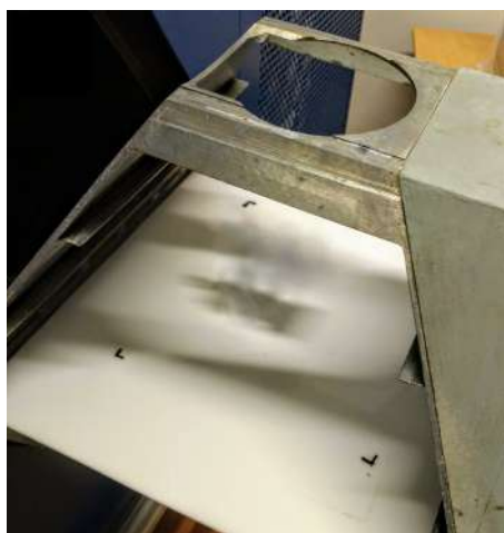
Rysunek 4.4: Komora aparatu Scanditronix, w której próbki są napromieniane promieniowaniem fotonowym. Zdjęcie wysuwanej szuflady, na której umieszczany jest materiał biologiczny do napromieniania. Próbkę jest umieszczana pomiędzy znacznikami, co zapewnia równomierny rozkład dawki. Następnie szuflada jest wsuwana do urządzenia i rozpoczyna się odsłanianie źródeł, a następnie napromienianie.
