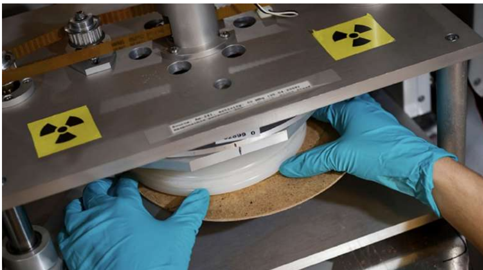
Rysunek 4.3: Urządzenie AIF 08, w którym znajduje się źródło ameryku. Zdjęcie urządzenia, w którym materiał biologiczny jest umieszczany na ruchomym stoliku automatycznie przysuwającym się do źródła. Dzięki temu odległość pomiędzy powierzchnią źródła a napromienianym materiałem jest niewielka i odtwarzana w każdym pomiarze.
