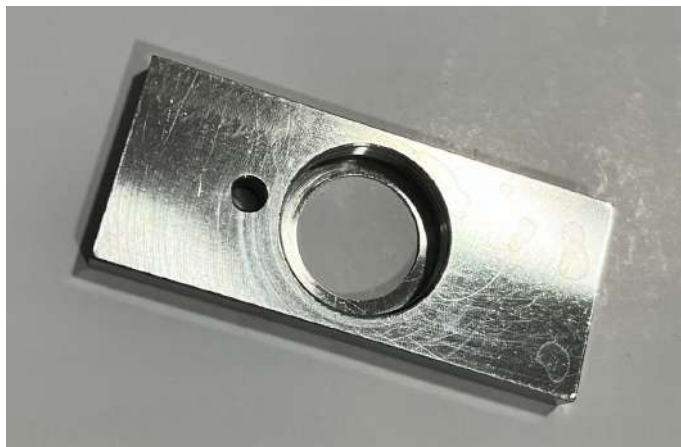
Rysunek 4.8: Komora ze stali nierdzewnej do obrazowania komórek na żywo. Komora ma studzienkę bez dna, w której umieszczane jest okrągłe szkiełko nakrywkowe z komórkami. Następnie dno ze szkiełkiem było uszczelniane pierścieniem O-ring z plastikową nakrętką Sykes-Moore. Do studzienki wprowadzana jest pożywka hodowlana, która zapewnia odpowiednie warunki komórkom obrazowanym przez kilka godzin.
