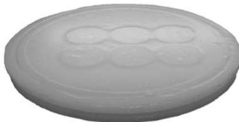
Rysunek 4.2: Poliamidowa płytka ze szkiełkami nakrywkowymi, na których są wysiane komórki. Szkiełka są przykryte cienką folią Mylar w celu odseparowania komórek od środowiska zewnętrznego.
