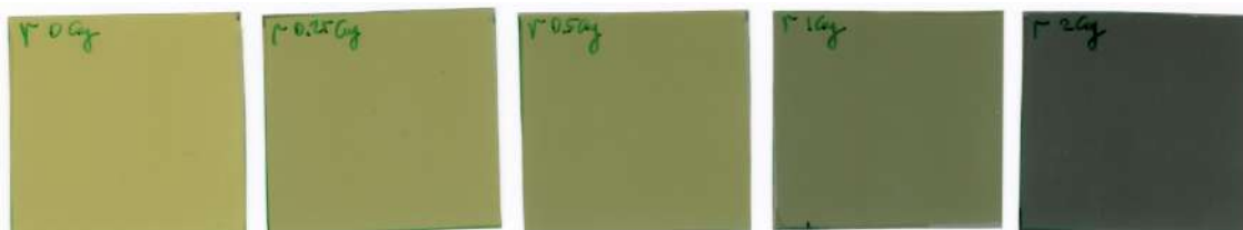
Rysunek 5.2: Skany filmów radiochromowych, które zostały napromienione czterema różnymi dawkami promieniowania fotonowego. Pierwszy film (najjaśniejszy) jest to film nie-napromieniony (próba kontrolna), natomiast pozostałe cztery zostały napromienione dawkami odpowiednio 0,25; 0,5; 1 i 2 Gy.
