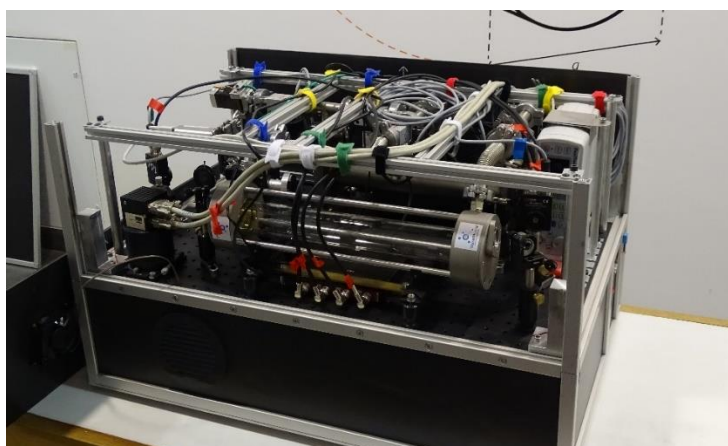
Rysunek 49: Układ przeznaczony do badań klinicznych – obudowa otwarta. Na pierwszym planie widoczna komórka wieloprzejściowa.
