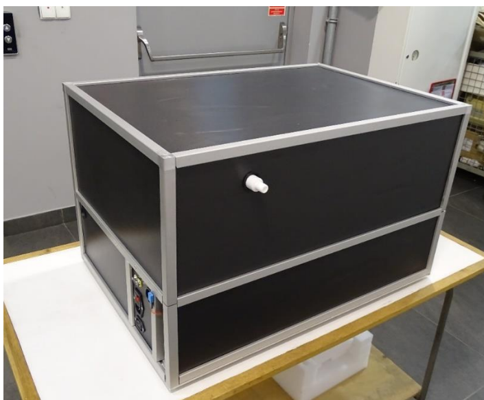
Rysunek 48: Układ przeznaczony do badań klinicznych – obudowa zamknięta. Na pierwszym planie widoczne przyłącze do podłączenia węża, którym pobierana jest próbka powietrza od badanej osoby.
