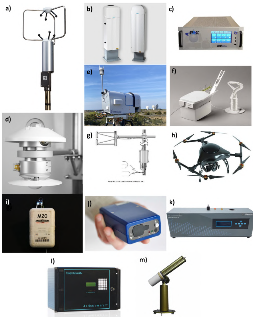
Rysunek 2.1: Zestawienie zdjęć aparatury użytej przy zbieraniu danych analizowanych w niniejszej pracy doktorskiej. a) Young 81000, b) Vaisala CL-31, c) PAX, d) CMP21 Kipp & Zonen, e) HATPRO-G5, f) Vaisala RS92-SGP, g) Campbell KH20, h) Versa X6sci, i) Meteomodem M20, j) Aethlabs AE-51, k) Aurora 4000, l) Magee AE-31, m) CIMEL CE318-2 Sun Sky. Wszystkie zdjęcia zostały pobrane ze stron producentów.
