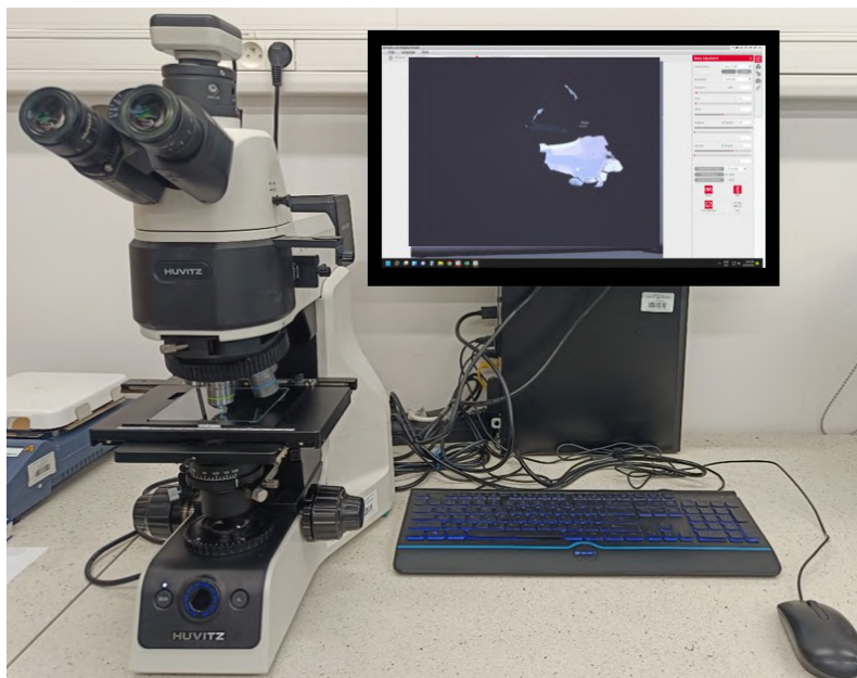
Rysunek 2.15. Mikroskop optyczny Huvitz wykorzystywany do identyfikacji i selekcji płatków na podłożach krzemowych oraz PDMS.
