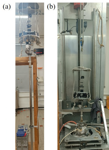
Rysunek 4.5. Zdjęcia układu pomiarowego w Grenoble: (a) kriostat z próbką oraz układem optycznym umieszczonym nad nią; (b) kriostat umieszczony w magnesie rezystywnym.
