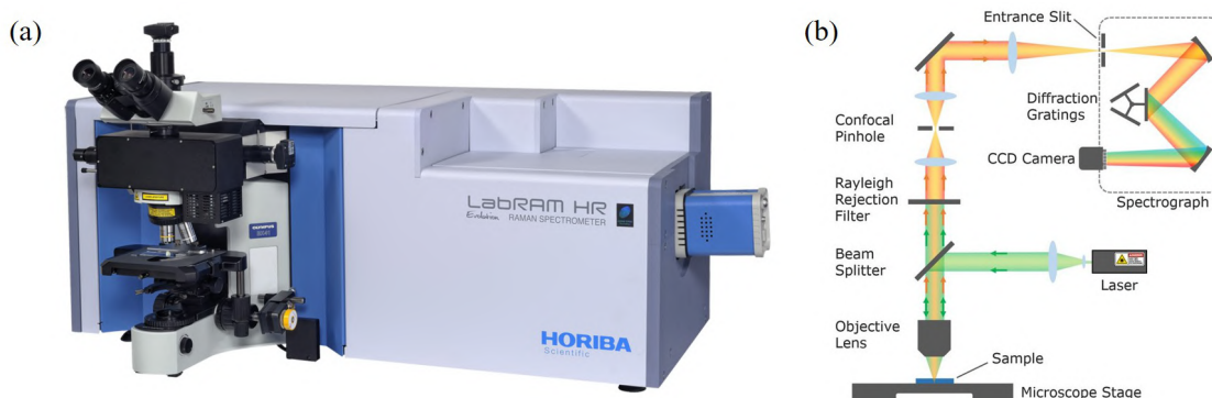
Rysunek 4.7. (a) Spektrometr LabRAM HR Evolution. Zdjęcie zaczerpnięte z [297]. (b) Schemat układu optycznego konfokalnego mikroskopu ramanowskiego zaczerpnięty z [298].
