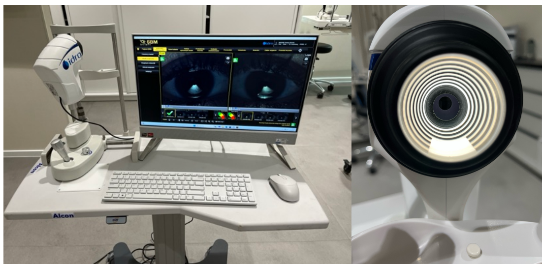
Rysunek 38 Zdjęcie urządzenia IDRA® Ocular Surface Analyzer, po lewej widok operatora, wraz z wynikami pomiaru LLT, po prawej widok czaszy służącej do pomiaru LLT (widok od strony pacjenta)
