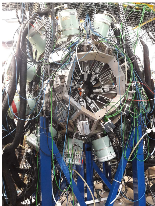
Fot. 1. Układ eksperymentalny v-ball array znajdujący się w ośrodku badawczym Laboratoire de Physique des 2 Infinis Irène Joliot-Curie (Alto, Orsay, Francja).
