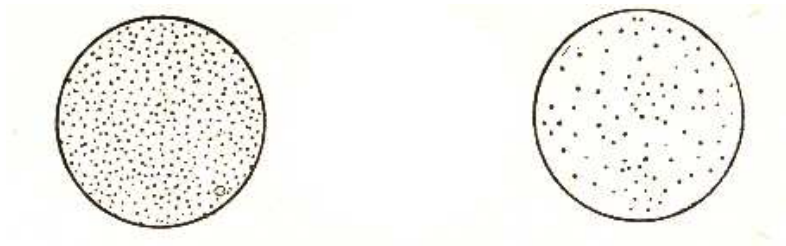
Rysunek 3.3: Schematyczny widok zawiesiny pod mikroskopem dla dwóch położeń tubusu mikroskopu oddalonych od siebie o \Delta . Lewy obraz dotyczy plasterka leżącego niżej a prawy tego leżącego wyżej. Jak widać, istnieje wyraźna różnica liczby makrocząsteczek na obu wysokościach, co stanowi kluczową obserwację w doświadczenia Perrina.
