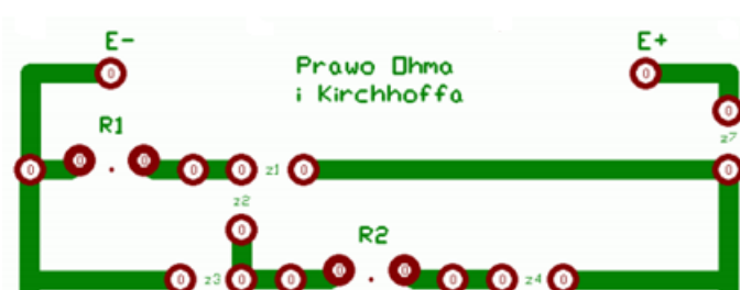
Rysunek 4. Schemat układu płytki drukowanej do sprawdzania Praw Ohma i Kirchhoffa.
