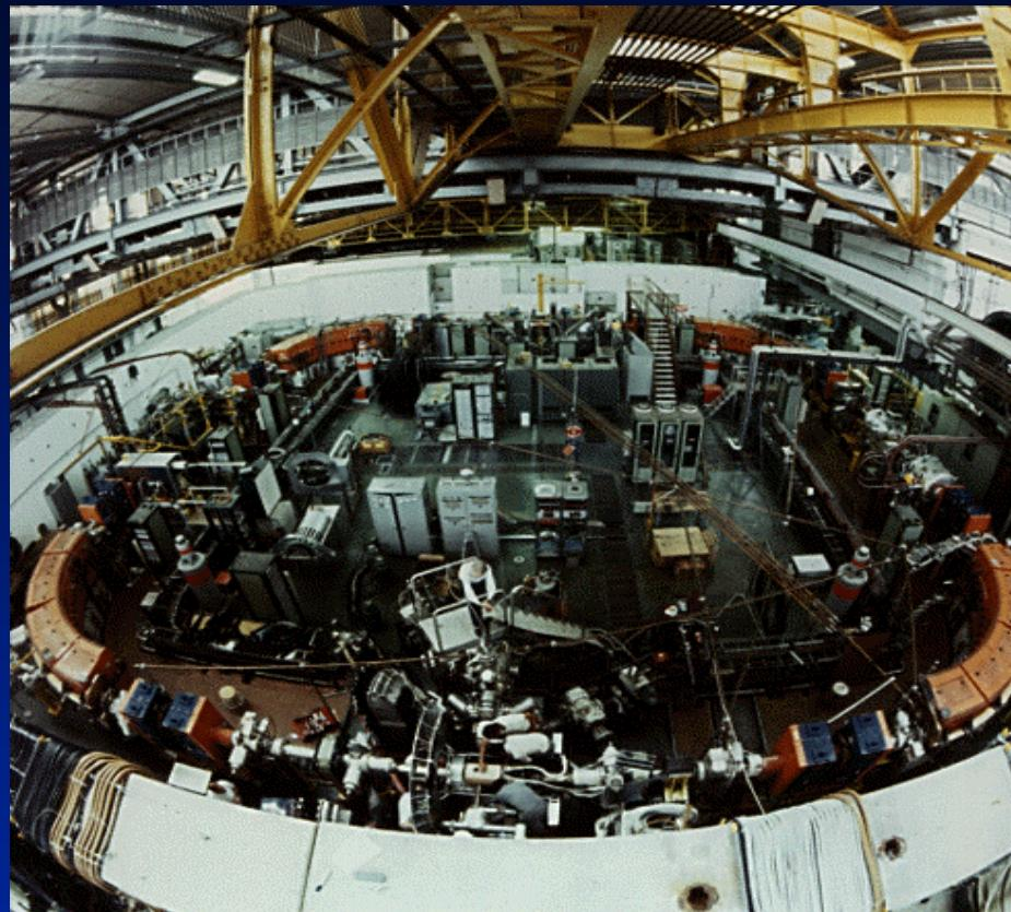
W pierścieniu akumulującym LEAR antyprotony wchodzące z pędem  $0.6 \text{ GeV}/c$  są spowalniane do  $100 \text{ MeV}/c$  (ok.  $5 \text{ MeV}$  energii kinetycznej)
