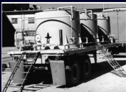
Zbiornik wypełniony 4500 litrami ciekłego scyntyлятора
