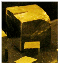
Rys. 6.10. Piryt – kryształ o strukturze kubicznej
