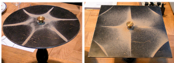
Rys. 11.16 Płytki z figurami Chładniego
