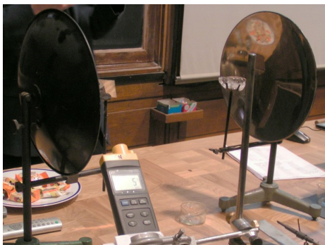
Rys. 14.9 Podczerwień chłodzi. Termometr widząc lód pokazuje 5°C.
