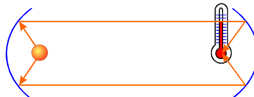
Rys. 14.8 Transmisja ciepła przy pomocy podczerwieni.
