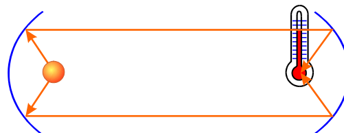
Rys. Q.15 Transmisja ciepła przy pomocy podczerwieni.
