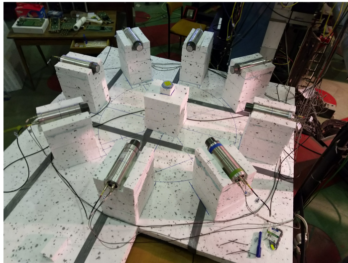
Rysunek 1: Układ pomiarowy. W promieniu 0.5 m od źródła ^{60}\text{Co} umieszczonych było 8 detektorów z kryształem \text{LaBr}_3 .
