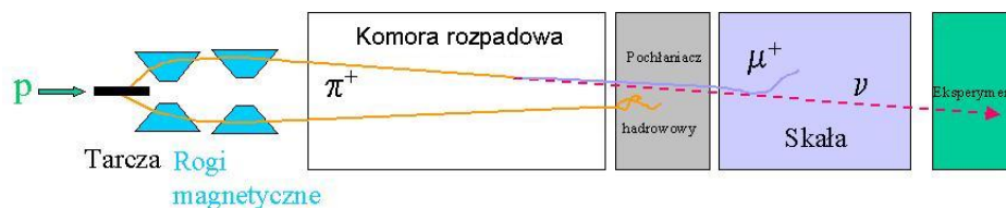
Rysunek 3.2: Schemat urządzeń produkujących wiązkę neutrin [10]
