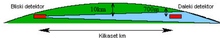
Rys. 4.12. Schemat eksperymentów z długą bazą pomiarową. Bliski detektor jest zawsze ustawiony niedaleko źródła neutrin, zaś daleki oddalony jest o setki kilometrów. Rysunek pokazuje schematycznie rozmycie wiązki neutrin (wartości liczbowe podane są dla wiązki NuMI) [14].
