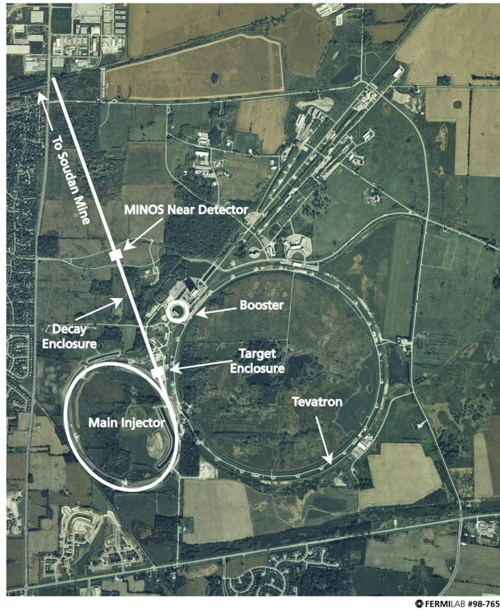
Rys. 4.8. Schemat kompleksu akceleratorów w ośrodku Fermilab [14]
