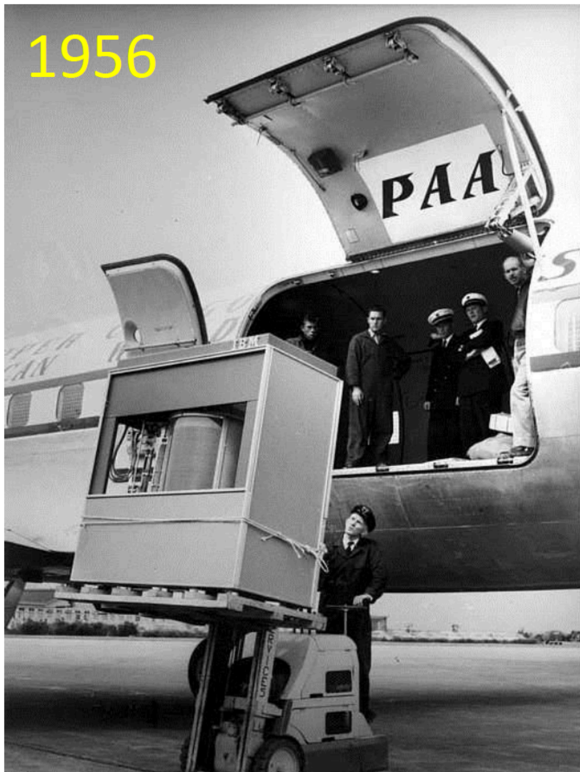
Dysk twardy IBM Model 350 Pojemność 5MB
