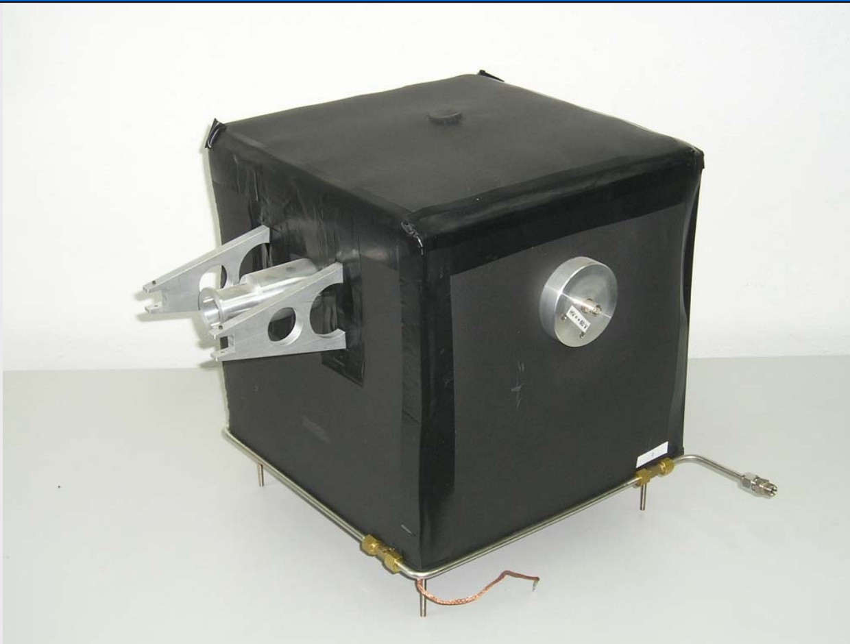
Komora dryfowa z odczytem optycznym (OTPC – optical time projection chamber)
