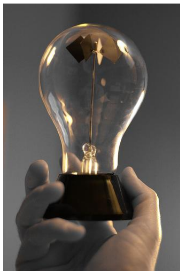
Rys. 5.2. Wiatraczek umieszczony w bańce próżniowej obraca się oświetlony strumieniem światła
