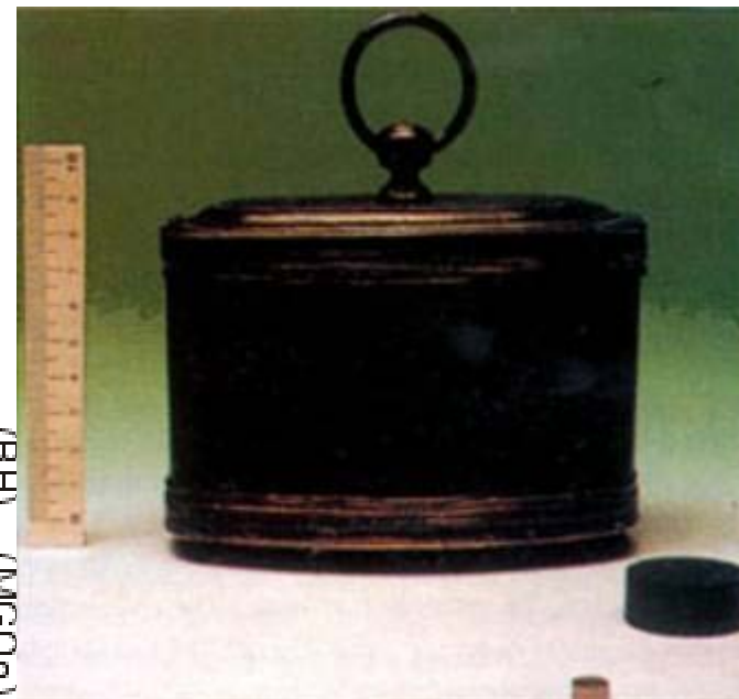
Magnetyt (z 1750 r.) typowy ferryt i magnes z ziem rzadkich. Każdy z nich o gęstości energii 1J.
