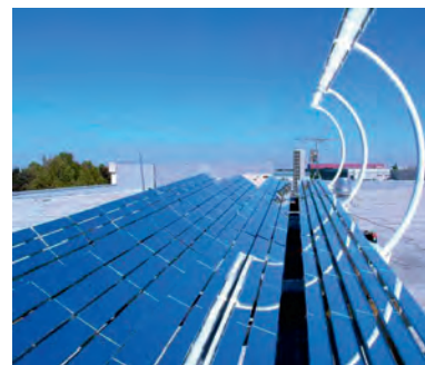
Fot. 6.19. Kogeneracyjny moduł fotowoltaiczny firmy Heliodynamics. Powierzchnia modułu wielkości 32 m 2 (to nieco więcej niż bok autobusu piętrowego) dostarcza do 10 kW ciepła i 1,5 kW prądu. W słonecznym kraju to ważące tonę urządzenie mogłoby dostarczyć dziennie jakieś 60 kWh ciepła oraz 9 kWh prądu. Te wartości odpowiadają średnim przepływowi rzędu 80 W/m 2 ciepła i 12 W/m 2 prądu (na m 2 powierzchni modułu); przepływy te są zbliżone do przepływów generowanych przez standardowe kolektory słoneczne oraz panele fotowoltaiczne, ale koncentrujący moduł Heliodynamics generuje energię taniej, ponieważ zbudowany jest głównie ze zwykłego płaskiego szkła. Dla porównania przeciętny Europejczyk zużywa 125 kWh energii dziennie .
