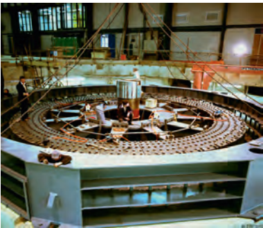
Fot. 26.15. Jedno z dwóch kół zamachowych w zakładzie badań nad syntezą jądrową w Culham (w budowie). Fot. EFDA-JET www.jet.efda.org
