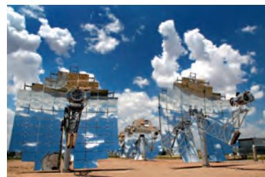
Fot. 25.3. Talerz z silnikiem Stirlinga. Te wspaniałe koncentratory dostarczają moc na jednostkę powierzchni rzędu 14 \text{ W/m}^2 . Zdjęcie zamieszczamy dzięki uprzejmości Stirling Energy Systems www.stirlingenergy.com Fot. 25.3. ABB
