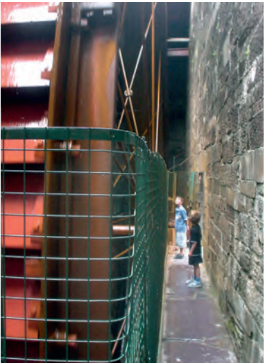
Fot. 8.4. Koło wodne o mocy 60 kW
