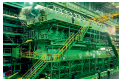
Fot. A.15. 14-cylindrowy, dwusuwowy silnik diesla Wartsila-Sulzer RTA96-C. Długość 27 m, wysokość 13,5 m. www.wartsila.com
