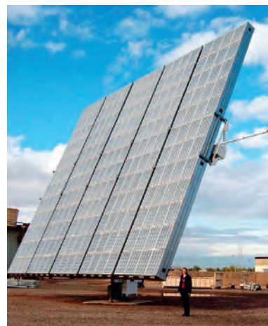
Fot. 25.9. Kolektor fotowoltaiczny z koncentracją o mocy szczytowej 25 kW produkowany przez kalifornijską firmę Amonix. Instalacja o rozmiarze 224 \text{ m}^2 zawiera 5760 soczewek Fresnela z 260-krotną koncentracją optyczną, z których każda oświetla silikonowe ogniwo o sprawności 25%. Jeden taki kolektor, odpowiednio ulokowany na pustyni, generuje 138 kWh dziennie – to wystarczy, by zaspokoić potrzeby energetyczne połowy Amerykanina. Podaję to „ludzkie” porównanie dla lepszego zilustrowania skali potencjału.
