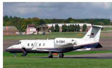
Fot. C.10. „Proszę zapiąć spinki do mankietów”. Bombardier Learjet 60XR przewożący 8 pasażerów z prędkością 780 km/h ma koszt transportowy rzędu 150 kWh na 100 pasażerokilometrów . Fot. Adrian Pingstone
