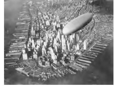
Fot. C.14. 239-metrowy USS Akron (ZRS-4) przelatujący nad Manhattanem. Ważył 100 t, zabierał 83 t ładunku. Całkowita moc silników wynosiła 3,4 MW. Przewoził 89 członków załogi i ładunek broni z prędkością 93 km/h. Służył również jako powietrzny lotniskowiec.
