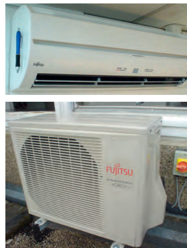
Fot. 21.11. Zewnętrzne i wewnętrzne elementy powietrznej pompy ciepła o współczynniku wydajności 4. Dla porównania obok wewnętrznej części umieszczono długopis. Ta pompa ciepła Fujitsu może dostarczyć 3,6 kW ciepła, przy zużyciu zaledwie 0,845 kW prądu. Może też pracować w odwrotną stronę, dostarczając 2,6 kW chłodu i zużywając 0,655 kW prądu.
