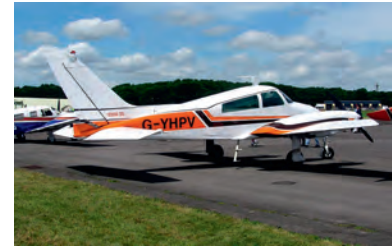
Fot. C.9. Cessna 310N: 60 kWh na 100 pasażerokilometrów. Cessna 310 Turbo przewozi 6 pasażerów (w tym 1 pilota) z prędkością 370 km/h.
