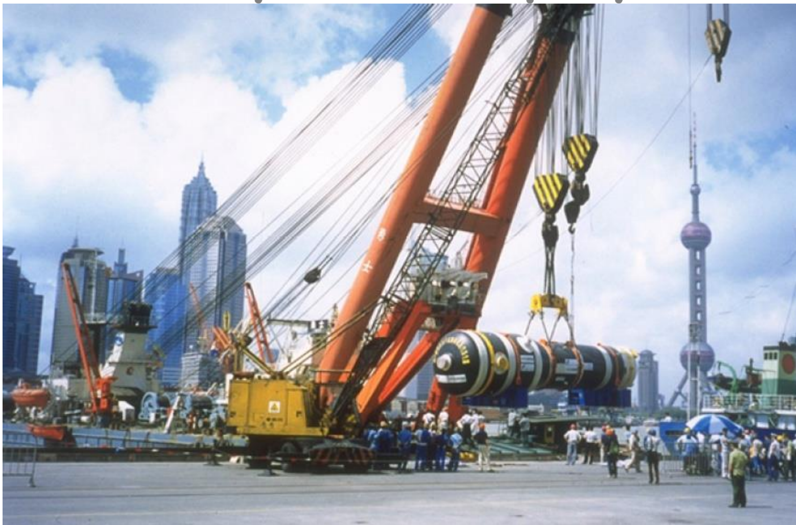
Transport wytwornicy pary dla reaktora nr 2 elektrowni Ling Ao. Port w Szanghaju (Chiny). Copyright AREVA.
